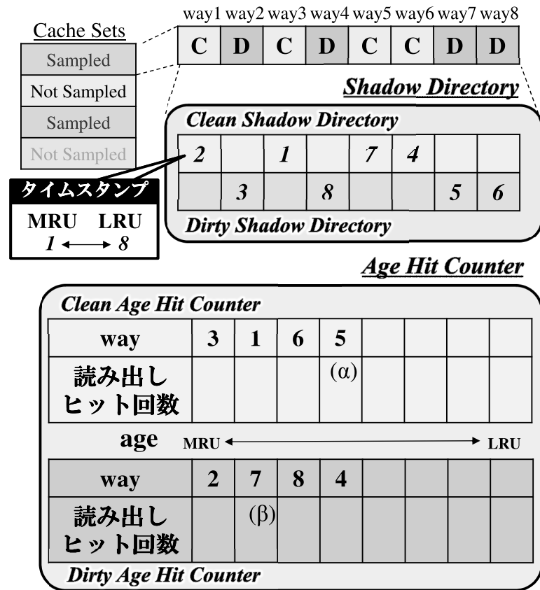
図 4: RWP を実装した 8way セットアソシアティブキャッシュの状態例
